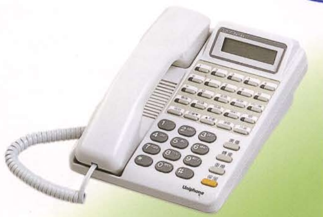
型號：UD-F 12TD/12TDHF 12外線顯示型數位話機(12TD) 12外線顯示型免持對講數位話機(12TDHF) (25 keys彈性功能鍵)
