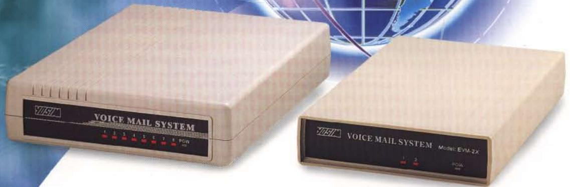
EVM語音系統是單體結構，使用快閃記憶體儲存資料的先進設計，具備全固態無磨損、體積小、低耗電...等優良特點，可全年運轉無當機之虞，摒除了傳統以PC為架構的語音信箱系統使用硬碟機及散熱所產生的問題。
